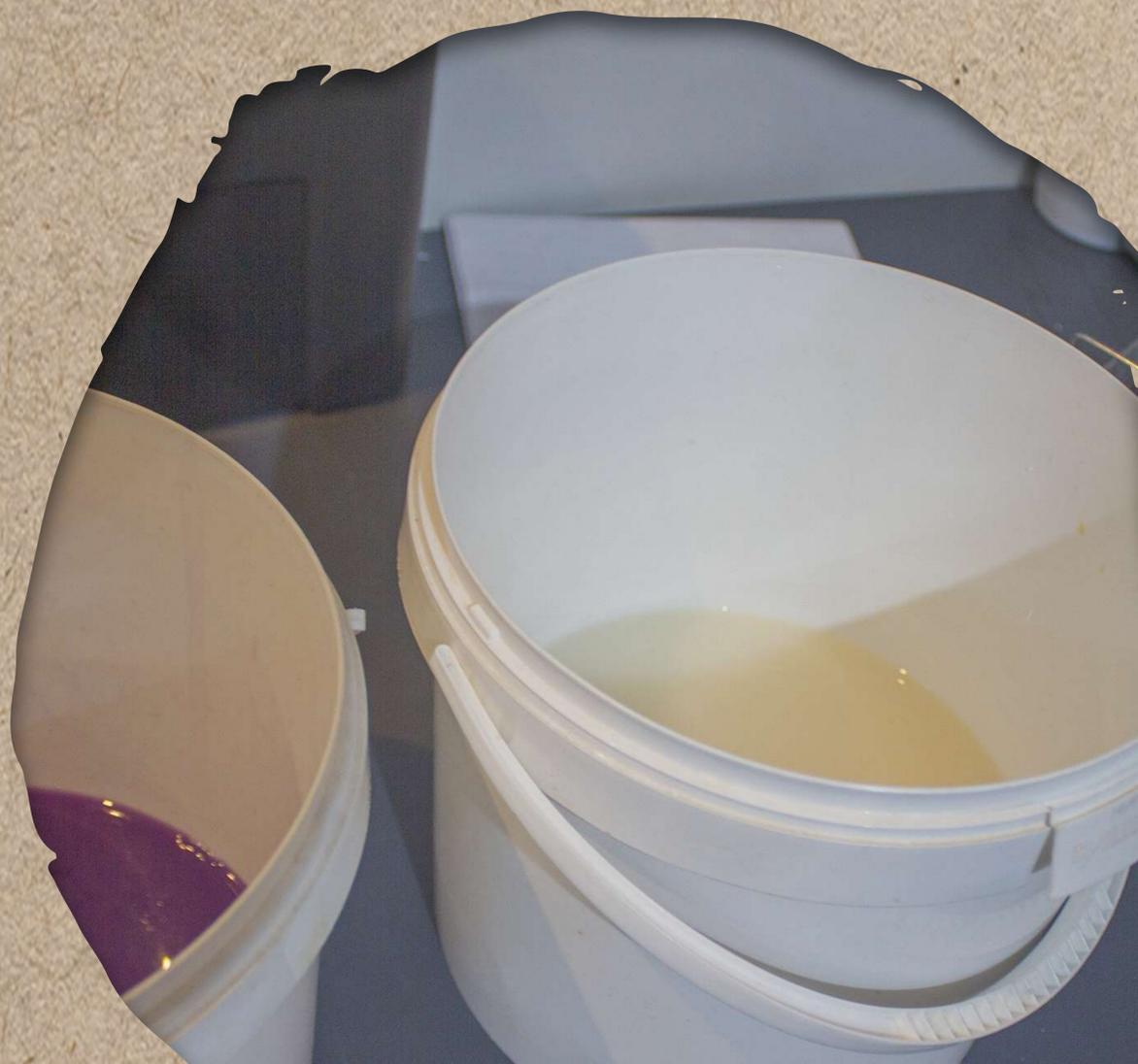
Como a resina é **fotosensível**, ela irá se solidificar após um tempo, se separando do material usado na limpeza, seja álcool ou água.
